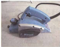
电刨子示例图 (用于刨平板材)
