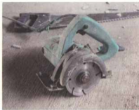
小型云石机示例图 (用于墙面开槽)
