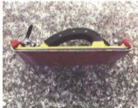
墙面打磨工具示例图
